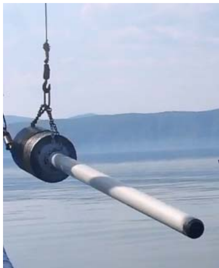
Донный пробоотбор с помощью гравитационной трубки
