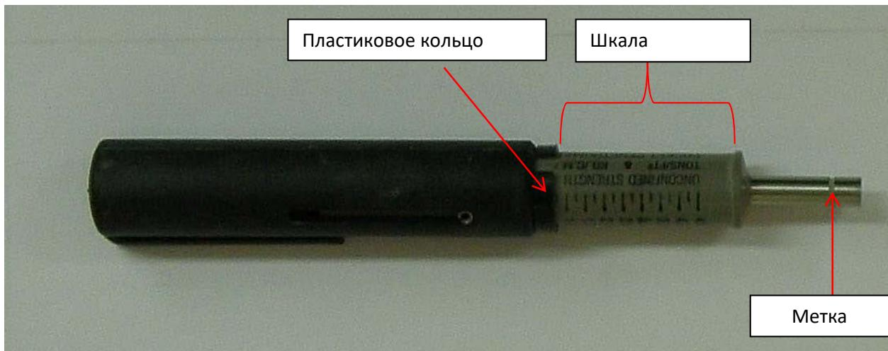
Рисунок 2. Пенетрометр
