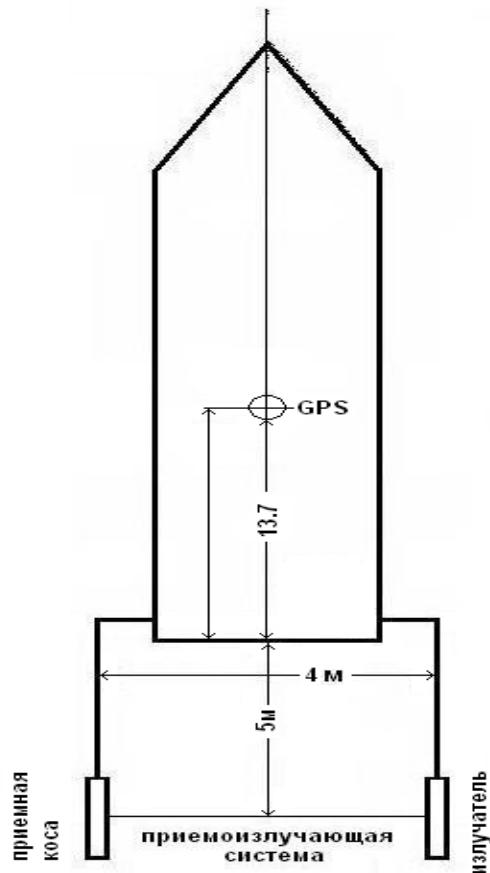
*Рисунок 4. Схемы буксировки приемоизлучающей системы.*
