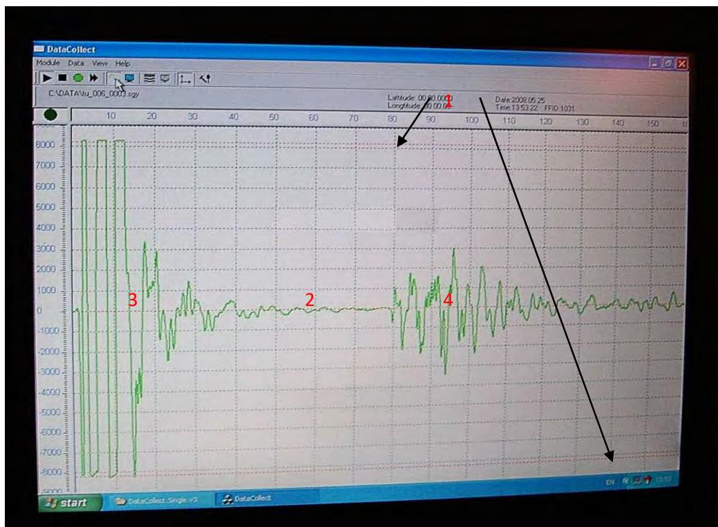
Рисунок 2. Амплитудный режим визуализации записываемых данных. 1 - линия (ограничения) контроля амплитуды сигнала; 2 - сейсмоакустическая трасса в амплитудном виде; 3 - прямой сигнал; 4 - донный сигнал.
