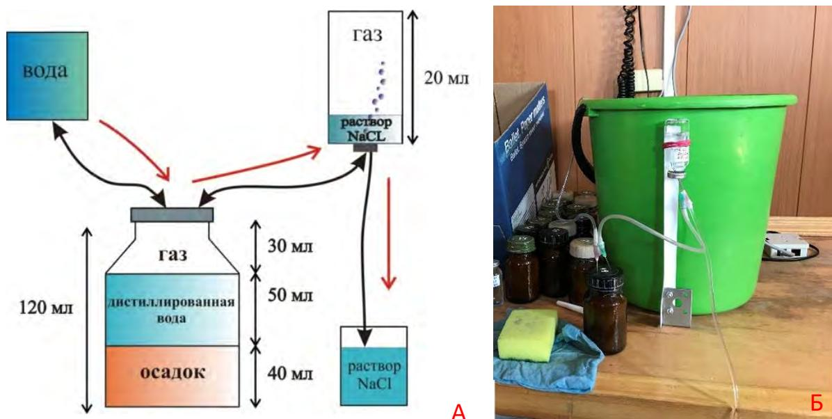
Рисунок 2. А - Схема дегазации и консервации газа методом «Head-Space», Б – Дегазация на борту НИС «Г.Ю. Верещагин»
