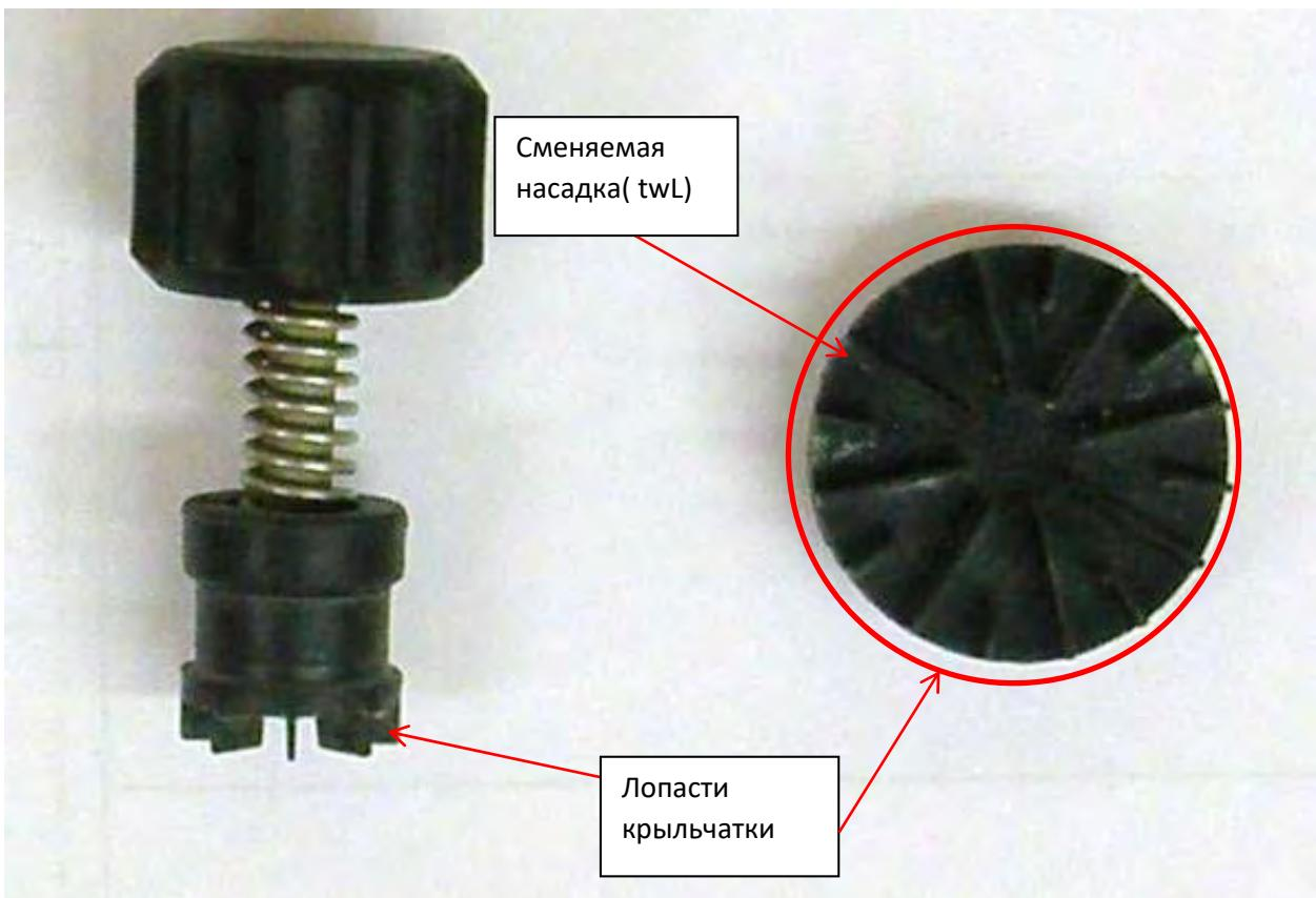
Рисунок 1. Крыльчатка (вид сбоку)
